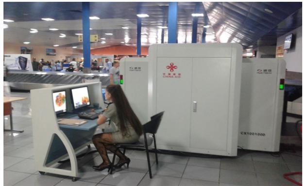
*Equipo de RX de doble generador para re-chequeo en los controles de entrada*
