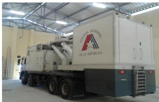
**Módulo de inspección RX control de contenedores-móvil, con sistema de detección de material radiactivo acoplado (actualmente ubicado en el puerto de Santiago de Cuba)**
